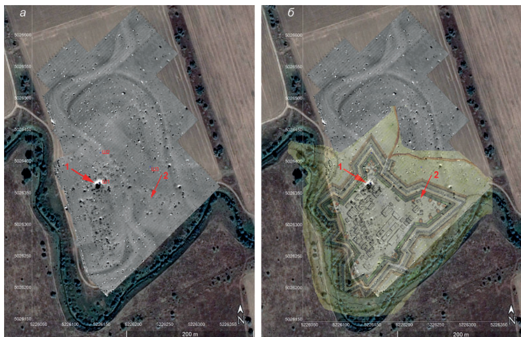
Рис. 3. а – Магнитная карта территории Салгирской крепости. Темным тоном показаны положительные магнитные аномалии, светлым – отрицательные. Красным шрифтом отмечены шурфы 1–3; б – совмещение плана Салгирского фельдшанца 1778 г. и магнитной карты. Стрелками и цифрами 1 и 2 показано местоположение двух артиллерийских погребов, отмеченных на чертеже крепости (рис. 2). Чертежи Т.Н. Смекаловой.
